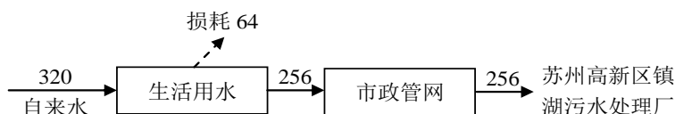
图 3-3 项目实际情况水平衡图 (单位: \text{m}^3/\text{a} )
